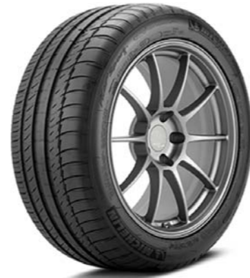
Gambar 3.14 Ban mobil diberi alur untuk memperbesar gaya gesek
